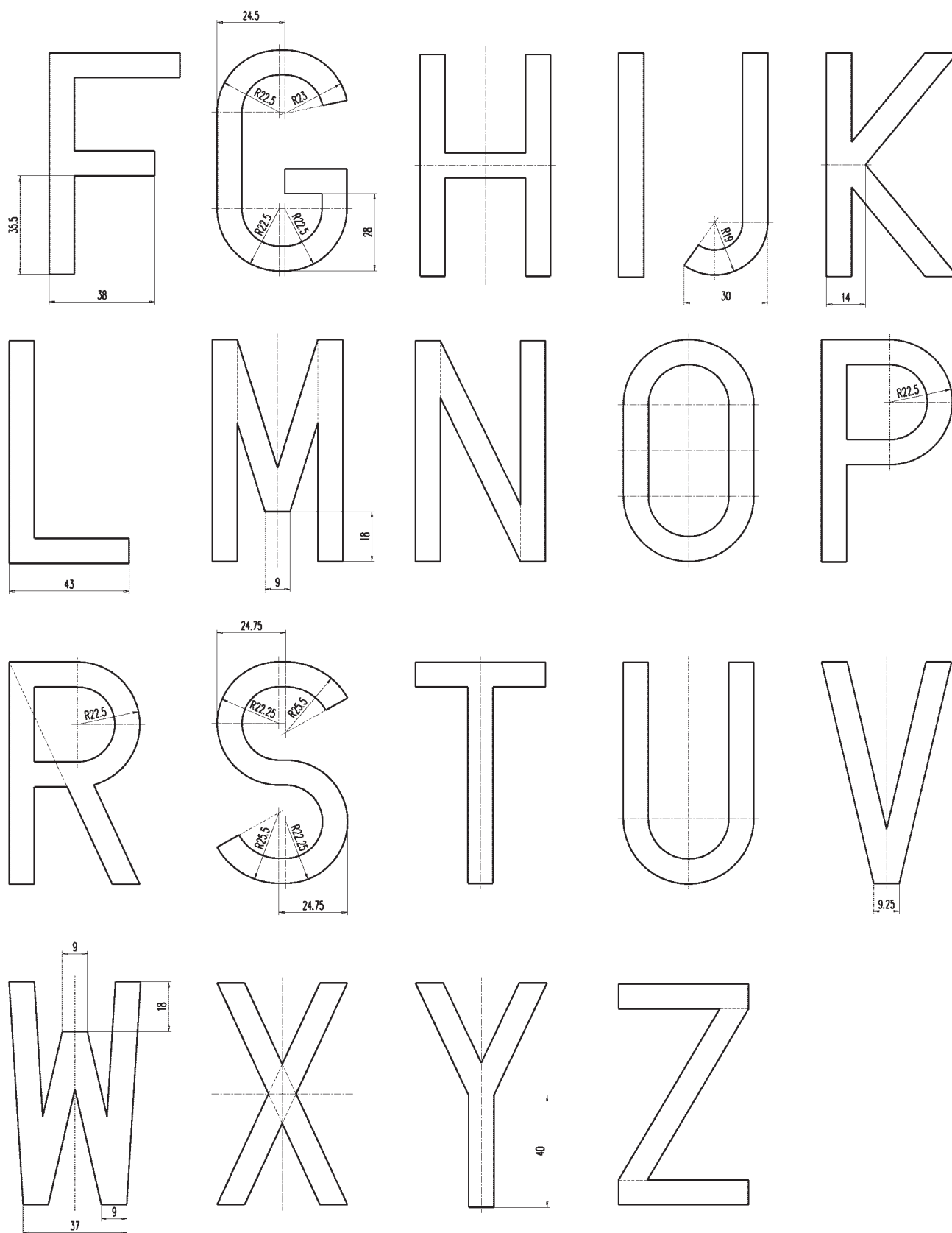
Rysunek 7. Wzory zwężonych liter do tablic samochodowych
