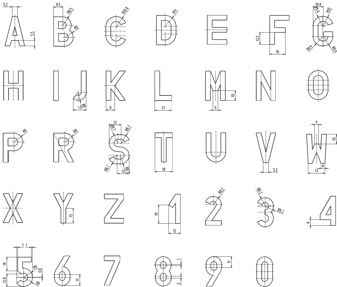
Rysunek 10. Wzory liter i cyfr do tablic motorowerowych
