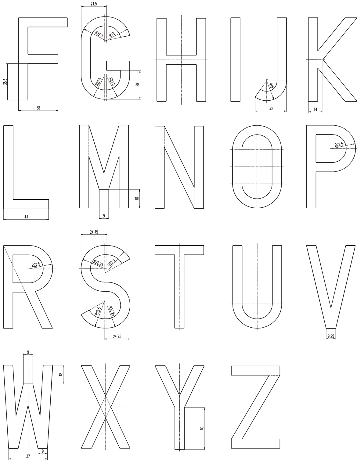
Rysunek 7. Wzory zwężonych liter do tablic samochodowych.
