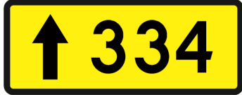
Rys. 6.3.7.13. Znak E-15b z numerem drogi wojewódzkiej ze strzałką kierunkową skierowaną na wprost”
