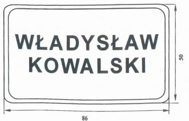
Rys. nr 2. Rysunek wymiarowy (wymiary w mm)
