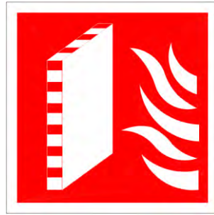
Rys. nr 1. Znak – „Ściana oddzielenia przeciwpożarowego”.
