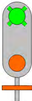
Rys. 19. Sygnał S 11a
