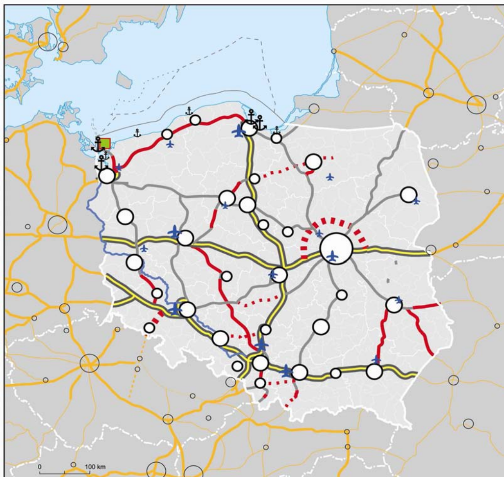
Rysunek 22. Przewidywany rozwój sieci drogowej na tle sieci lotnisk, portów morskich i Odrzańskiej Drogi Wodnej - II etap*
