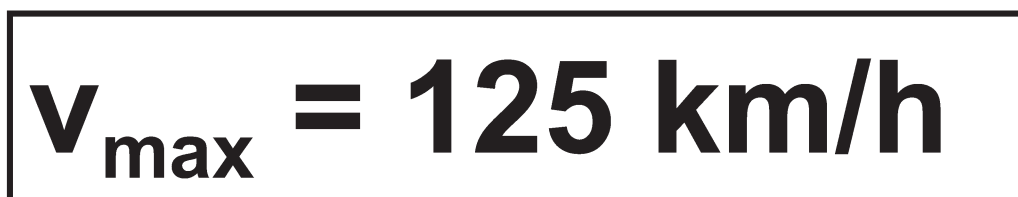
Rys. 5. Wzór wykonania tabliczki określającej dopuszczalną prędkość eksploatacyjną pojazdu trakcyjnego lub specjalnego oraz pojazdu metra, umieszczanej nad stanowiskiem maszynisty.
