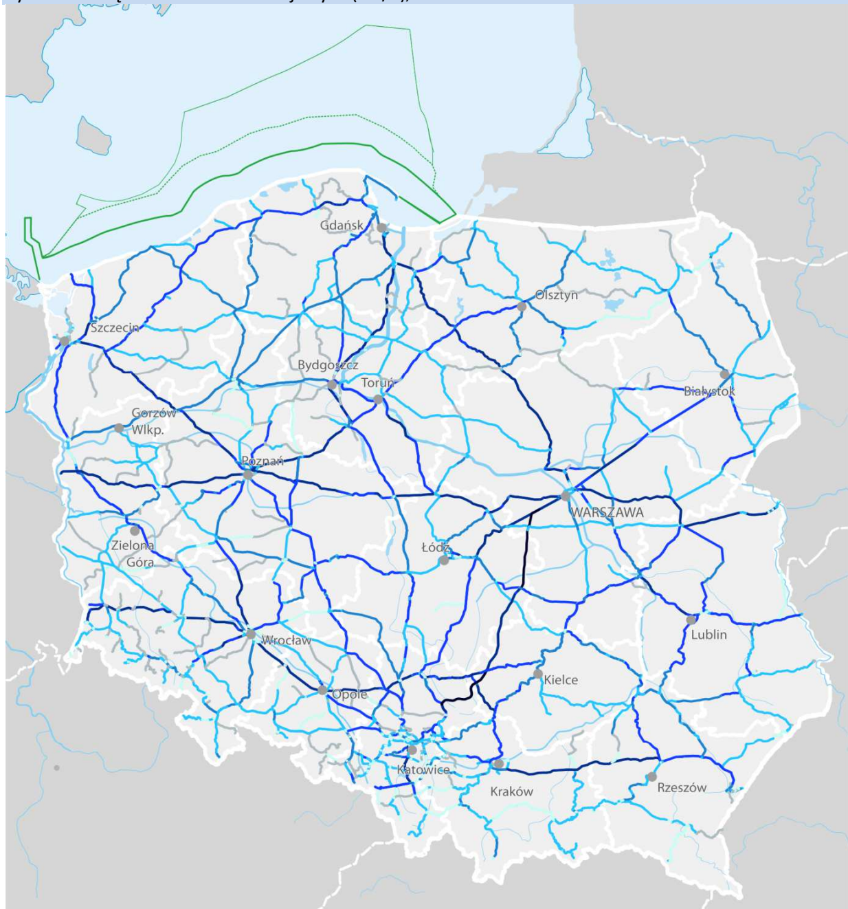
Rysunek 4. Prędkości na liniach kolejowych (km/h), stan na 2017 r.
